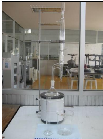
รูปที่ 61 ชุดทดสอบหาปริมาณน้ำในผลิตภัณฑ์ปริโตรเลียมและวัสดุปิโตรเมนโดยการกลั่น
