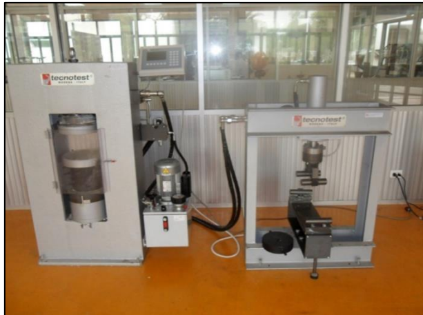
รูปที่ 4 เครื่องทดสอบแรงกดคอนกรีต
