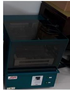
3. ตู้ควบคุมอุณหภูมิแบบเขย่า ชนิดตั้งโต๊ะ.
